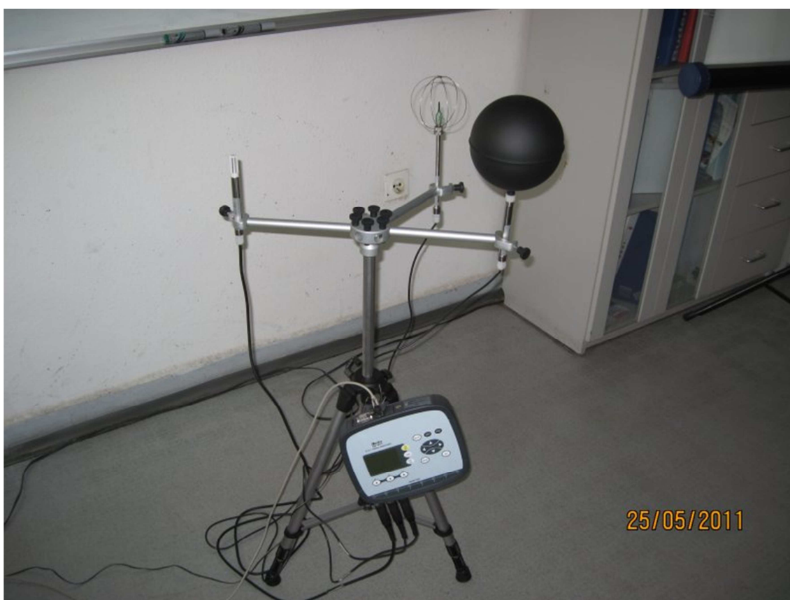
Rys. 1. Stanowisko pomiarowe do pomiaru parametrów mikroklimatu w pomieszczeniu
