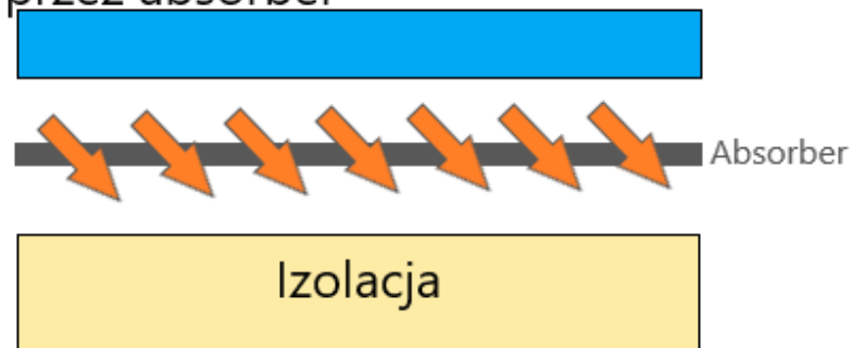
Kolektor z przepływem powietrza przez absorber
