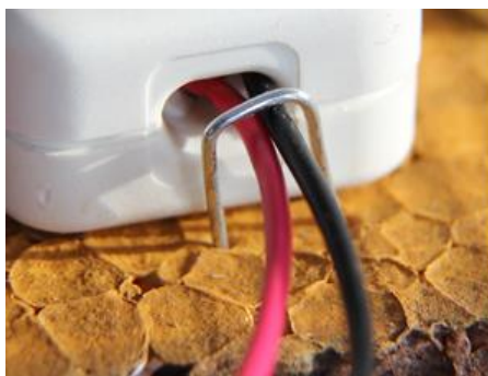
Stabilizowanie kabli zszywkami zrobionymi ze spinaczy biurowych
