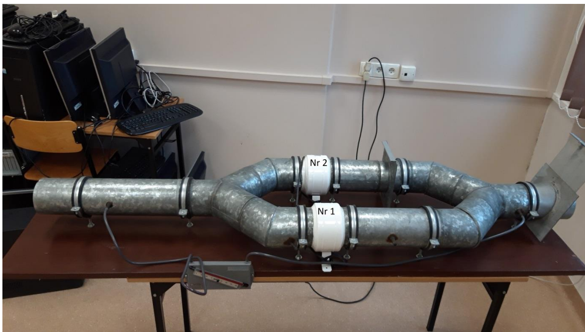
Rys. 1 Zdjęcie stanowiska pomiarowego z wentylatorami osiowymi współpracującymi równolegle
