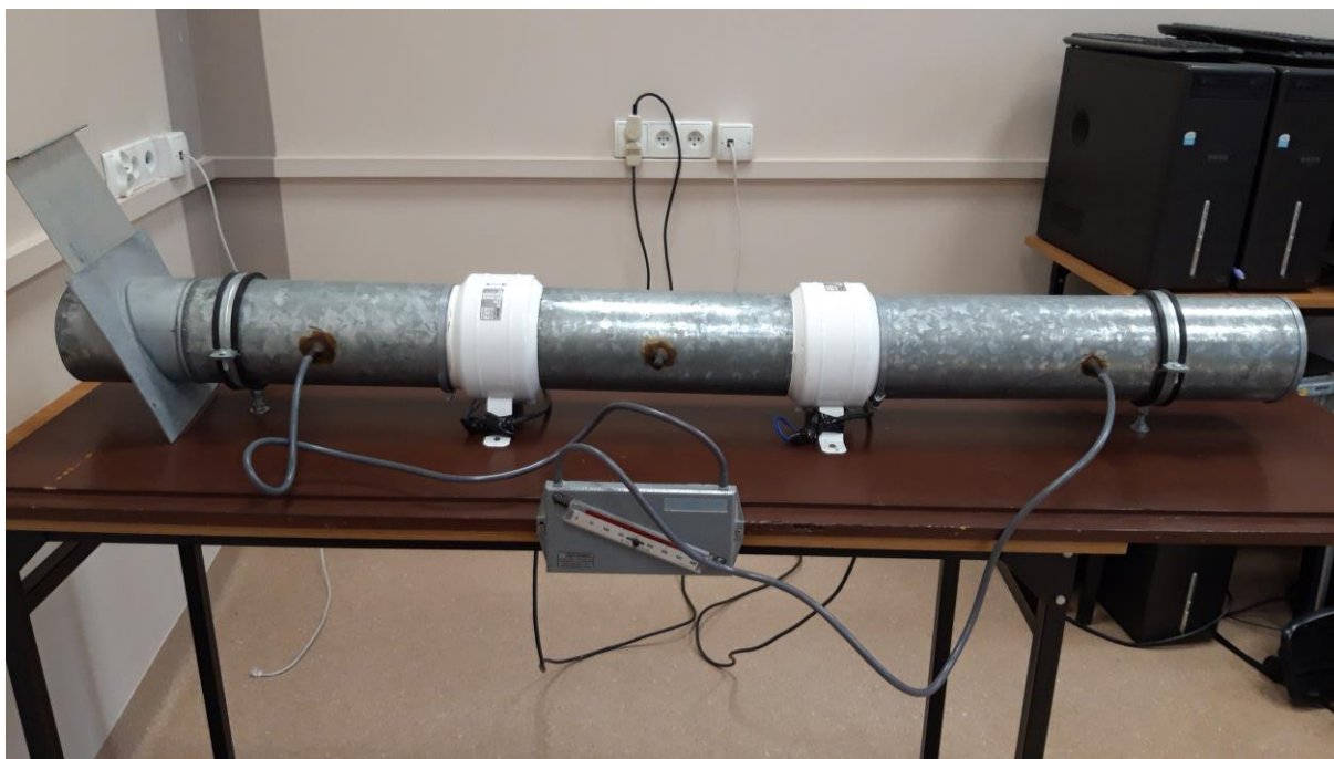
Rys. 1 Zdjęcie stanowiska pomiarowego z wentylatorami osiowymi współpracującymi szeregowo
